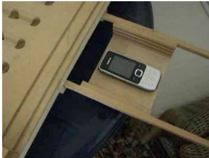
Abb. 1: Schublade zur Aufnahme des Mobiltelefons unterhalb der Messebene
