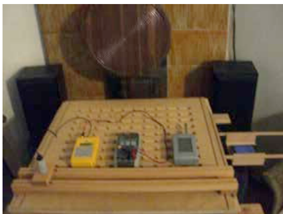
Abb. 9: Messplatz für Mobiltelefone. Rechts im Bild ein iPhone in der Lade, die unter das Messfeld geschoben wird. Hinten die Zentralsonne.
