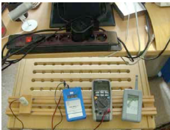
Abb. 5: Arbeitsplatz mit Kabeln und Netzteil als Belastungsquellen; im Vordergrund Messraster mit Messgerät, Datenlogger und Thermo-Hygrometer zur Messung von Temperatur und Luftfeuchte.
